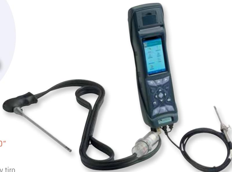
Sensor de presión interno de alta precisión para medida tiro
